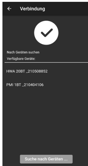
Nachdem das Gerät gefunden wurde (z. B. PCE-HWA 20BT), kann durch Antippen des Geräts in der Liste eine Verbindung hergestellt werden. Nach erfolgreichem Verbindungsauftbau bekommt der Benutzer umgehend eine Bestätigung auf dem Display, dass die Geräte verbunden sind und wird direkt ins Hauptmenü weitergeleitet.
