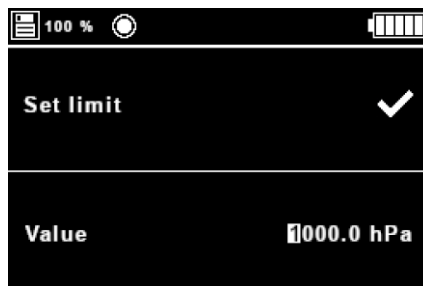
Abb. 24 Eingestellter Wert für Alarm
