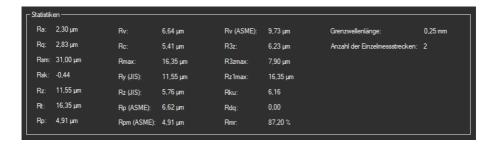
Die Statistik beinhaltet die wichtigsten R-Parameter. Außerdem werden zwei Einstellungen zur Messung angezeigt (Anzahl der Einzelmessstrecken und Grenzwellenlänge)
