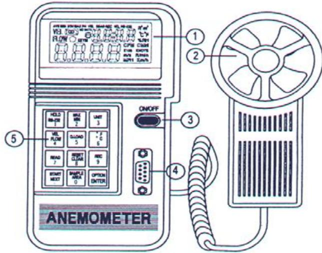
AVE = bu sembol ortalama akış ölçümü fonksiyonu seçildiğinde belirir.
