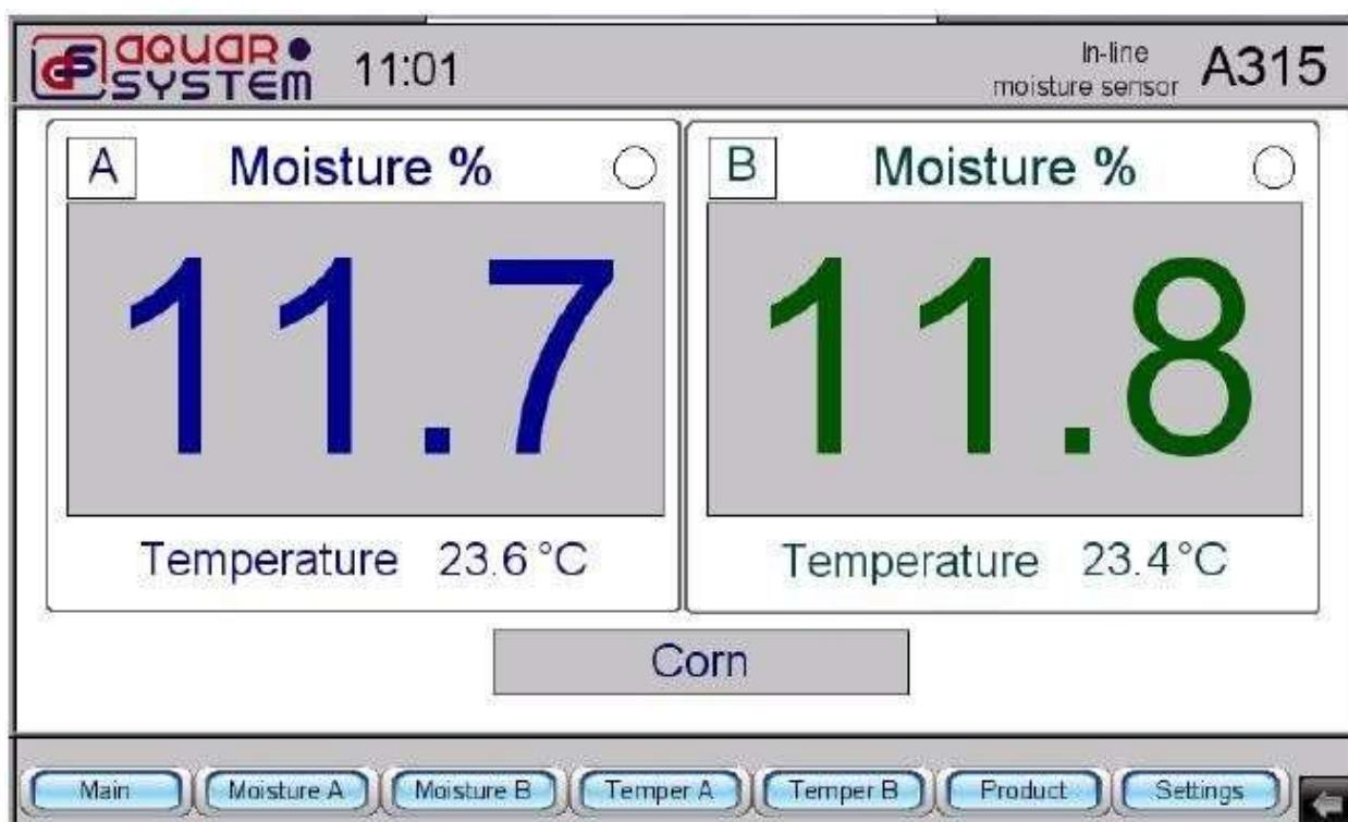
Örneğin, modda, B sensörüne karşılık gelen harfi basarsanız, bu sensör kapanır ve nem ve sıcaklık için belirtilen değerler sıfır olur.
