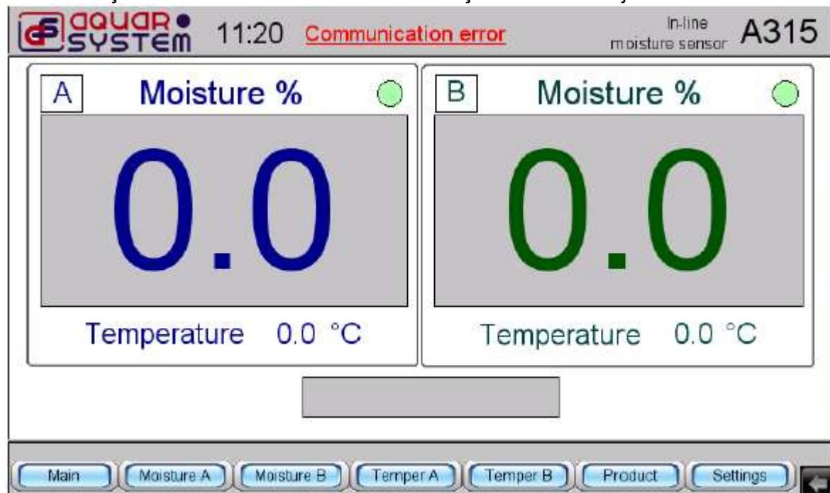
Bu durumda, nem sensörlerinden ekran paneline ve kontaklara olan kabloların sağlamlığı kontrol edilmelidir. Belirli kabloların arızaları, kontrol panelini kullanarak bir nem sensörünü kapatarak tespit edilebilir. Örneğin sensör B'yi kapatırsanız ve A sensörü çalışmaya başlarsa (nemi ve sıcaklığı gösterir) ve "İletişim hatası" mesajı kaybolursa, sensör B'den ekran paneline giden iletişim kablosu arızalıdır.
