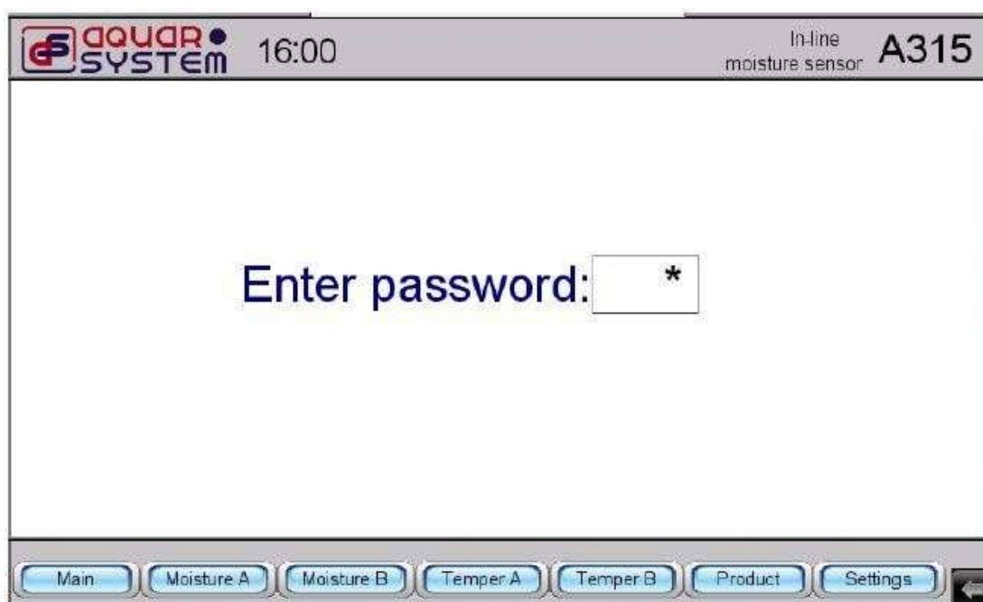
Tuş takımını kullanarak "315" girin ve **ENT** düğmesine basın. Aşağıdaki gösterge görüntülenir. Bir düzeltme yalnızca nem algılayıcılarından biri için yapılabilir. Sistem aynı anda iki sensör işletiyorsa veya her ikisi de kapalıysa, "Bir sensör seç" mesajı belirecektir. Gerekli sensörü seçmek için, ekranın sağ alt köşesindeki **A** veya **B** düğmesine basın. Seçilen sensör, ekranın sol üst köşesindeki ilgili harfle gösterilir. Sensör için ayarlanmış parametreleri okumak için **Update** basın.
