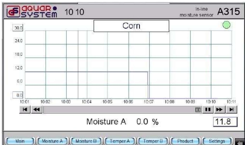
Nem ile ilgili trend ölçüği tuş takımı kullanılarak değiştirilebilir. Maksimum değeri değiştirmek için, grafiğin sol üst köşesindeki değeri seçin. Yeni maksimum değeri % 5'lük artışlarla yazabilmeniz için sayısal tuş takımı görünecektir. Onaylamak için sayısal tuş takımını kullanın. Minimum değeri Ayarlamak için aynı prosedür takip edilebilir. Tek fark, grafiğin sol alt köşesindeki değeri Seçmen iz gerekmektedir.
