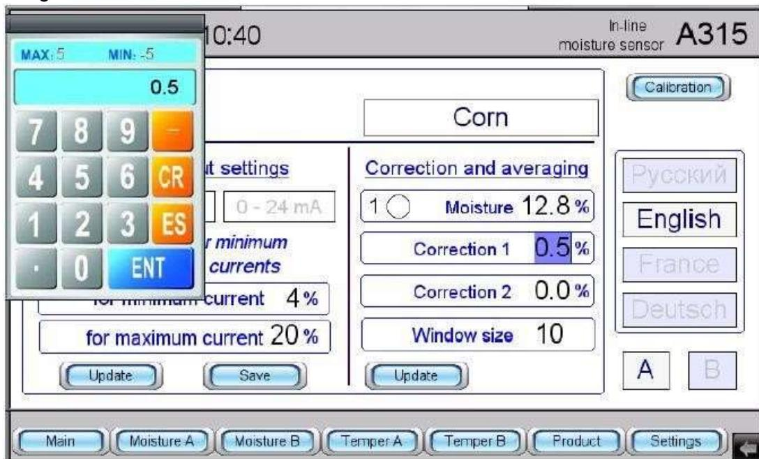
Algoritma 2 için nem düzeltme, bu durumda "Düzeltme 2" seçildiği tek farkla yukarıdaki ile aynı şekilde gerçekleştirilir.
