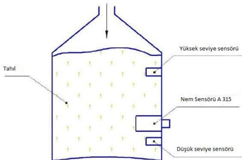
Şafta tahlı doldurduktan sonra, nem sensörünün ölçüm kanalı da doldurulur ve mevcut nem ölçümü gerçekleştirilir. Tahlı seviyesi nem sensörünün altındaysa ve ölçüm kanalı da boşaldığında, nem sensörü sıfır okur ve otomatik kalibrasyon yapılır (yeşil LED yanar). Tahlının yeni bir kısmı sensöre doldurulduktan sonra, nem ölçme işlemi tekrarlanacaktır.
