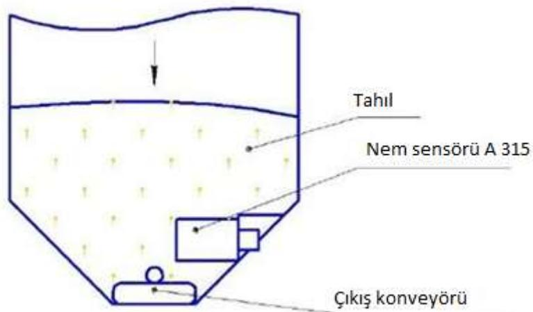
Kurutulmuş hububatın belirli bir bölümünün boşaltılmasından sonra, nem sensörü tahlı ile tamamen kaplanmalıdır. Tahlı yavaş yavaş nem sensörünün ölçüm kanalından geçer ve bir çıkış konveyörü tarafından taşınır. Rutubet ölçümü, tahlı, nem sensörünün ölçüm kanalından
