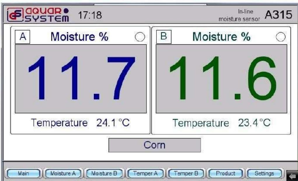
Nem kontrol sistemindeki tane nem ölçümünün hat içi işlemini taklit etmek için, çeşitli nem sensörü dolumlarının sonuçlarına dayalı olarak ortalama bir nem değeri elde etmeye yardımcı olan( özel bir test modu **Test** anahtarı) sağlanmaktadır. Bu değer, aynı tür tahılların gelecekteki dolumları için bir referans değer olarak işlev görür. Ürün seçiminizi yukarıda tarif edildiği gibi yaptıktan sonra **Test** düğmesine basın ve aşağıdaki resim görüntülenir.
