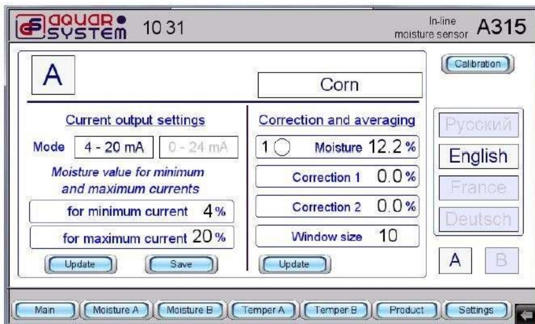
Nem sınır değerleri aşağıdaki gibi ayarlanır: Maksimum çıkış akımı için nem sınırını ayırmak için, aşağıdaki örnekte% 20 olan maksimum çıkış akımına karşılık gelen nem rakamına basın ve zaten vurgulanmıştır. Sayısal tuş takımını görünecektir. **ENT** Yeni bir değer girdikten sonra tuş takımında, ardından geçerli çıkış ayarlarında **Save** ve **Update** tuşuna basın. Minimum çıkış akımı aynı şekilde ayarlanabilir.
