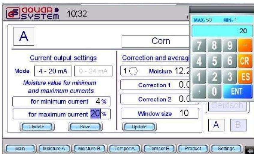
Mikrodalga nem sensörü iki algoritma kullanarak nemi hesaplar. Hesaplama algoritması tane rutubeti ve sıcaklığına bağlıdır ve 1 ve 2 basamakları kullanır. Bir sonraki ekranda, 1'inci rakamı, "Düzelme ve ortalamalama" menü maddesinde,% 12,2 değerinde ve %0,0 düzeltme ile görebilirsiniz.
