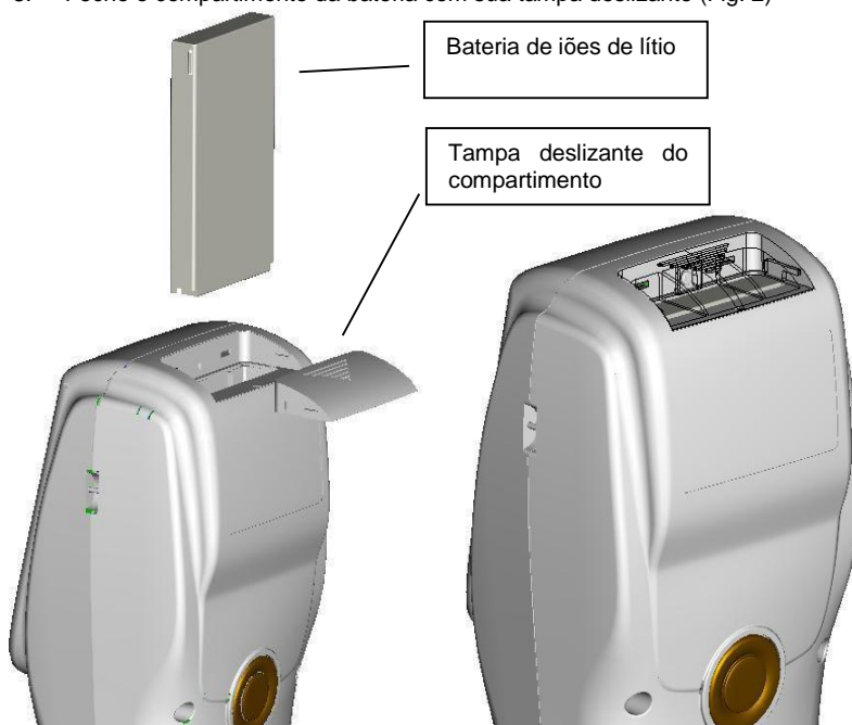
Fig. 2: Instalação da bateria
