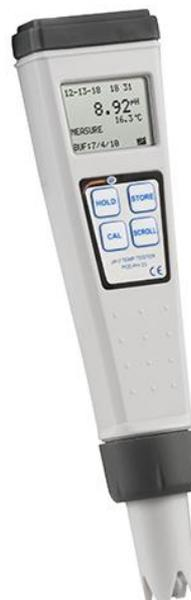
O medidor de pH digital, modelo, é usado para realizar análises rápidas de líquidos. O medidor de pH digital oferece a possibilidade de medir a temperatura e o valor pH. A operação do medidor de pH digital é realizada através das 4 teclas localizadas na parte da frente. O medidor de pH digital integra um eletrodo (eléctrodo) que é facilmente trocado. Basta com afrouxar o anel de fixação e remover o eletrodo.
