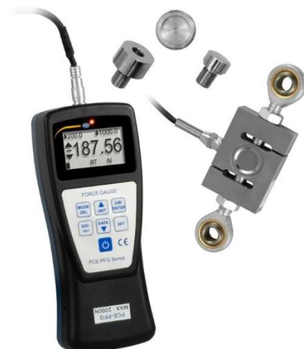
Este dinamômetro é um dispositivo digital e fácil de operar para medir forças de tração e compressão. O dinamômetro oferece uma frequência de amostragem de 500 Hz e diferentes possibilidades de medição, como medição em tempo real (RT), medição do valor de pico (PEAK), medição de média configurável (Average) e medição com registro automático de até 100 valores.
