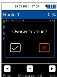
Fig. 21 Sobrescrever a medição de um ponto de medição para a medição de rota atual
