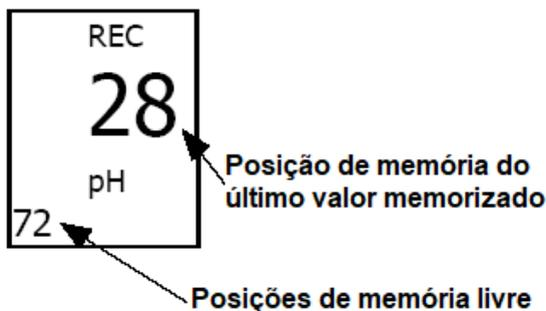
Para sair da função de memória mantenha pressionada a tecla "Rec" por 2 segundos. O aparelho retorna automaticamente para o modo de medição normal.
