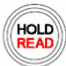
Pressionar este botão para manter os dados que aparecem no monitor LCD. Pressionar este botão e logo pressionar REC para gravar os dados do monitor. Pressionar novamente o botão HOLD para continuar com a operação
