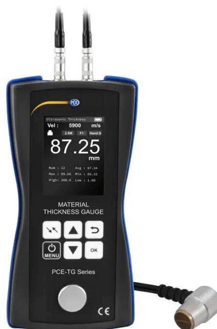
Este espessímetro realiza medições na faixa de até 300 mm. Para poder medir a espessura de diferentes materiais homogêneos o usuário pode ajustar a velocidade de ultrassom no espessímetro. Materiais como aço, alumínio, zinco, prata e ouro já estão integrados na biblioteca de materiais do espessímetro. Por este motivo, este espessímetro é um dispositivo de uso universal.
