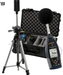
O sonômetro classe 1 cumpre os requisitos para a medição de ruído e análise de frequência. O sonômetro, além da medição do ruído, está equipado com um receptor GPS. A função GPS permite ao usuário atribuir os valores de medição a uma posição exata.
