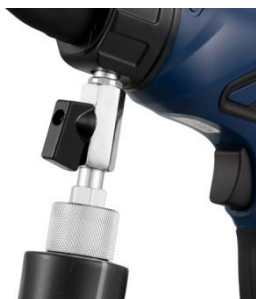
Vídeo endoscópio PCE-VE 250 com válvula de fechamento aberta.
