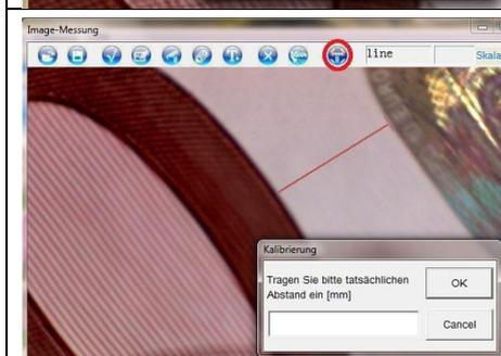
**Calibração:** Aqui poderá executar a calibração. Necessita uma imagem, que seja conhecida a distância ou a regra de calibração anexada. Esta distância é marcada na imagem e o valor inserido na janela de entrada em milímetros.
