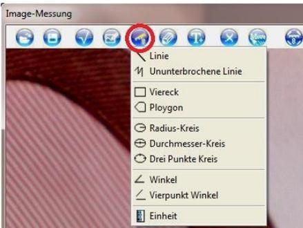
**Medição:** Depois de haver realizado uma calibração, poderá usar o microscópio para medições na imagem. Para isso, selecione um objeto adequado (por ex., círculo de três pontos) e marque os pontos de medição na imagem. O resultado de medição será exibido. Com um clique no mouse, o resultado na imagem é exibido
