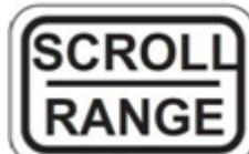
Ao pressionar a tecla SCROLL/RANGE será interrompida a medição em processo e o intervalo de medição passa para o seguinte nível (isto é, na parte inferior da tela do dispositivo). Ao pressionar novamente a tecla modificará o intervalo de medição ao nível superior, etc. O intervalo de medição escolhido será indicado através da luz de controle correspondente.
