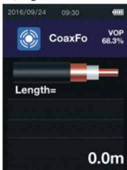
Modo de medição para cabos coaxiais e cabos conectados ao dispositivo através dos adaptadores de medição.
