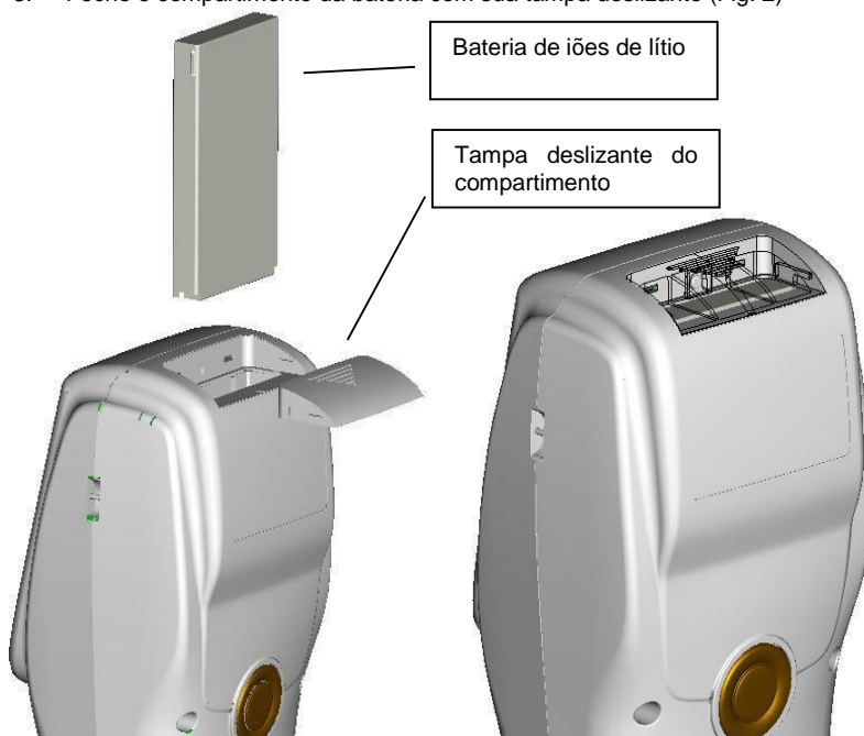
Fig. 2: Instalação da bateria
