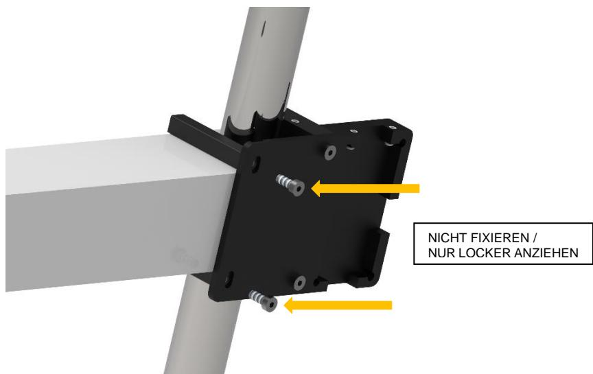
Nehmen Sie Bauteil (2) zur Hand und schrauben Sie dieses von hinten mit 4 Schrauben (Bauteil 10) an die Baugruppe. Achten Sie darauf, dass die Bauteile (4) in der Nut von Bauteil (2) sitzen. Schrauben Sie auch hier die an den Bauteilen (4) sitzenden Schrauben noch nicht fest.
