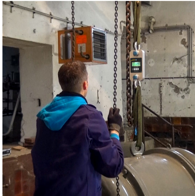
Kranwaage PCE-DDM 3WI-ICA /Messbereich bis 3 t / PEAK Funktion / inkl. Schäkel und Transportkoffer
