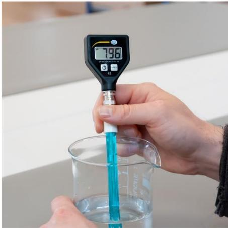
Die Stromversorgung des Messgeräts erfolgt über drei LR44 (AG13) Batterien, die bei Bedarf leicht ausgetauscht werden können. Bei Umgebungstemperaturen von 0 bis 50 °Celsius werden die Messwerte über eine eingebaute Temperaturkompensation automatisch ausgeglichen. Das leichte und handliche pH-Meter eignet sich damit nicht nur für Messungen an Proben im Labor, sondern auch für den Einsatz im Außenbereich.
