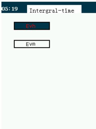
Mit dieser Einstellung werden die Luxwerte über einen bestimmten Zeitraum in Minuten oder Stunden bewertet. Die Einstellung unterstützt Sie bei der Langzeitbewertung der Lichtquelle bezüglich eventueller Schwankungen. Messen Sie die zu untersuchenden Lichtquellen und lesen Sie den Integralwert bei gleicher Integralzeit ab. Die Integralzeit wird Ihnen auf dem Display unterhalb der Grafik angezeigt.
