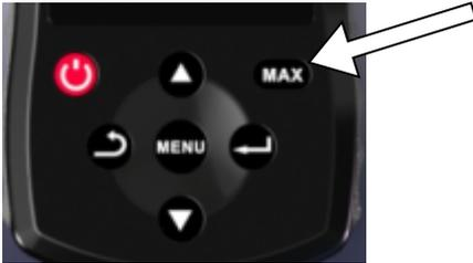
Das Gerät misst 10-mal in 5 Sekunden und der Maximalwert erscheint auf dem Display. In der Zwischenzeit werden die 10 Datensätze auf der SD-Karte gespeichert.
