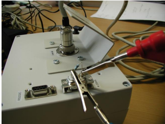
Prüfbeispiel der 4 -20mA Schnittstelle mit dem Widerstand R_{we} < 510 \Omega
