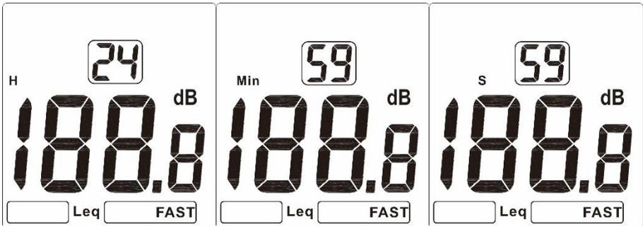
Pulse nuevamente la tecla "FAST/SLOW". El sonómetro iniciará automáticamente la medición según el tiempo ajustado.
