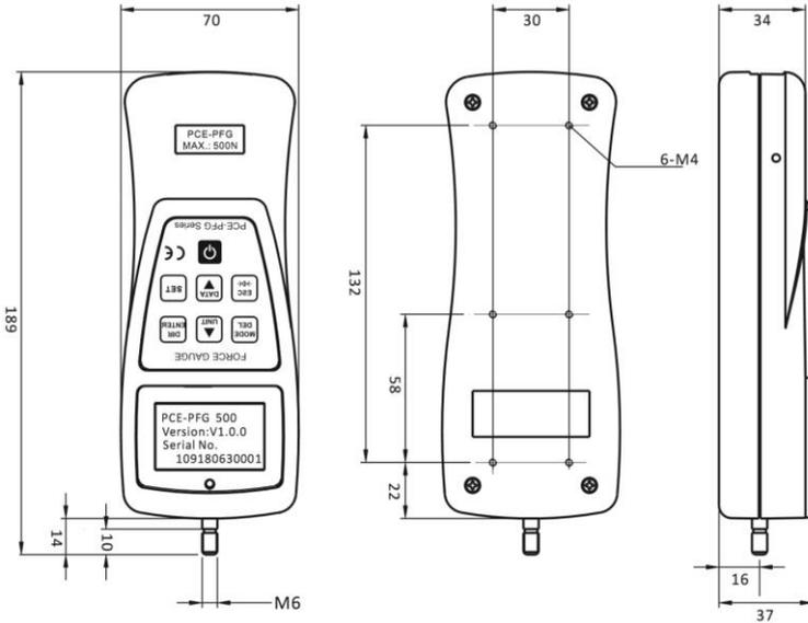
Dimensiones de los modelos con célula de carga externa
