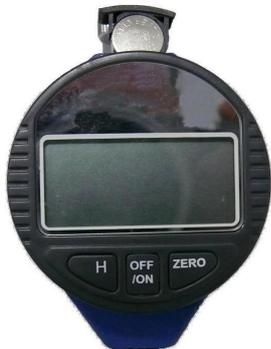
Para reemplazar la batería, inserte la punta del destornillador pequeño o similar y retire con cuidado la tapa del compartimento de la batería y el soporte de la batería. Coloque la nueva batería y posteriormente coloque el soporte y la tapa del compartimento. Tenga en cuenta la polaridad correcta.
