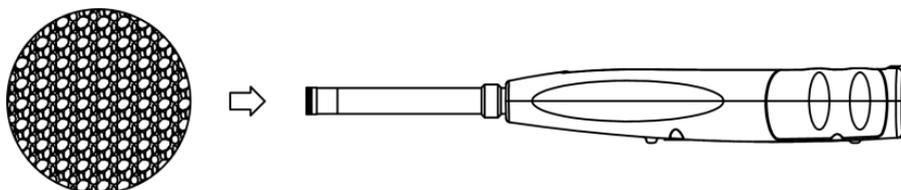
Fije el supresor de viento contra el micrófono, como se muestra en la imagen superior, hasta que llegue al tope. Para más detalles sobre correcciones del supresor de viento en exteriores, consulte el apartado 12.2 Correcciones .
