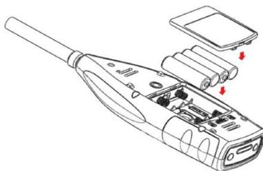
Reemplace las pilas, vuelva a colocar la tapa del compartimento y ciérrela.
