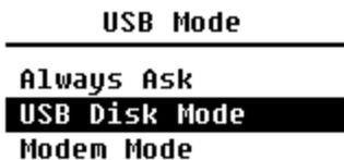
En el menú “**Modo USB**” puede configurar el modo de trabajo cuando se conecte el sonómetro mediante un cable USB al ordenador. Preguntar siempre, si puede seleccionar el modo disco USB y el modo de módem.
