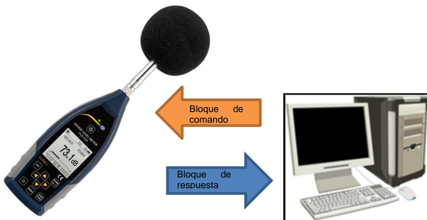
Un bloque de comando típico o bloque de respuesta se compone de un símbolo de iniciar, la ID, el símbolo de atributo, el comando o los datos, el símbolo de final, el símbolo de comprobación de bloque, los símbolos de retroceso de línea y retroceso de carro, según la siguiente tabla:
