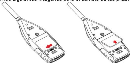
Desplace la pestaña de la tapa del compartimento de las pilas hacia la izquierda para abrirla. Extraiga la tapa del compartimento.
