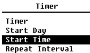
En el menú **“Temporizador”** puede configurar el temporizador, el día de inicio, la hora de inicio y el intervalo de repetición. Pulse la tecla ▲ y ▼ para la selección. El usuario puede programar la medición de tal manera, que empiece al día siguiente a las 00:00; dure varios minutos; y que se repita cada hora y así conseguir una medición automática durante 24 horas.
