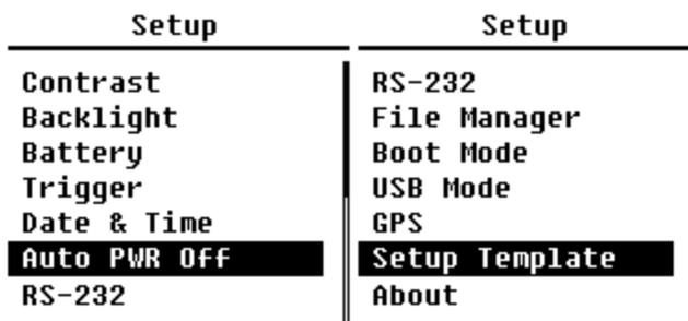
El menú “**Setup**” contiene la función básica de configuración y la visualización de la condición. Con las teclas ▲ y ▼ puede seleccionar la opción y abrir el siguiente nivel de menú con la tecla Enter.
