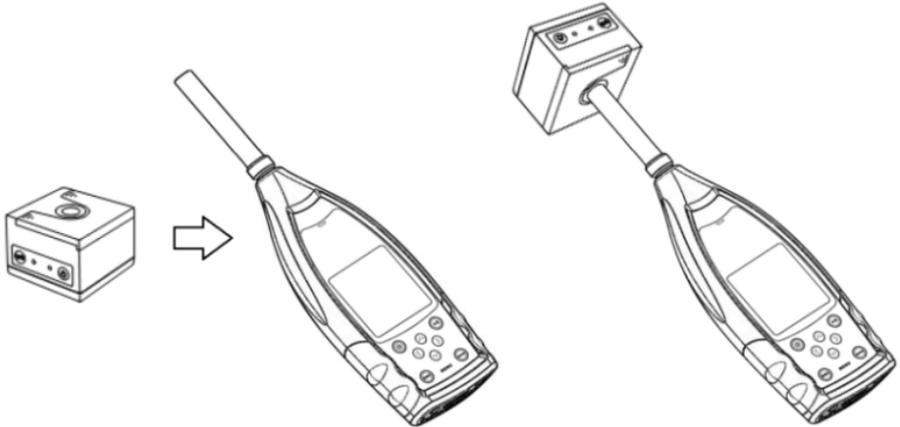
(2) A continuación encienda el calibrador y establezca el nivel acústico constante (p.ej. 94 dB).
