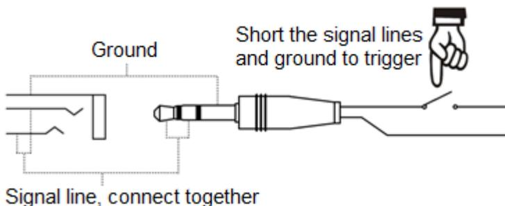
La medición se inicia al conectar una conexión del cable de señal con la masa y se para mediante su interrupción. Tenga en cuenta que cuando se habilita la función Trigger, la tecla Start/Stop no está disponible.
