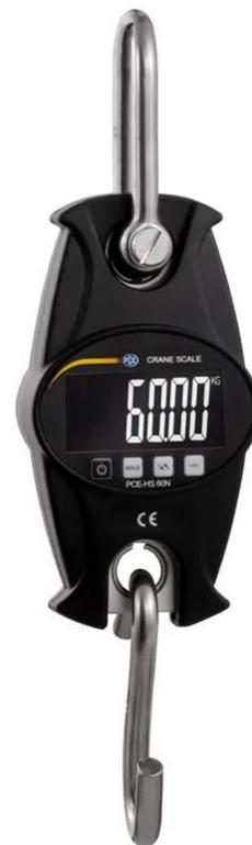
La balanza colgante con rango de pesaje de 0 ... 60 kg. La balanza colgante es un instrumento de medición exacto ya que pesa con una precisión de  $\pm 1$  % F.S. La pantalla LCD integra unos dígitos de 22 mm de altura. Esto, sumado al hecho que la pantalla cuenta con retroiluminación, permite que el usuario lea los valores desde cierta distancia, incluso en zonas con poca luz. Gracias a la carcasa metálica robusta puede usar la balanza colgante incluso en ambientes de trabajo adversos.
