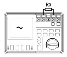
Conexiones de resistencia de CA
