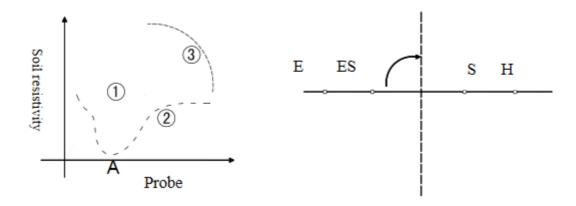
Gráfico 1: Cuando la profundidad aumenta y ρ no disminuye: se recomienda un electrodo conductor en forma de barra.
