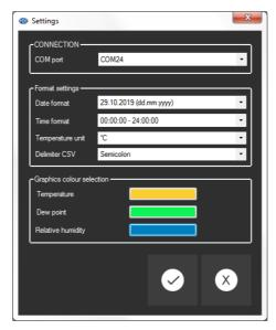
Además de los datos de conexión, aquí se pueden realizar otros ajustes para el formato de fecha y hora. Estos incluyen el formato de la fecha y la hora, el delimitador para archivos csv y la unidad de temperatura para mostrar los valores de la misma.
