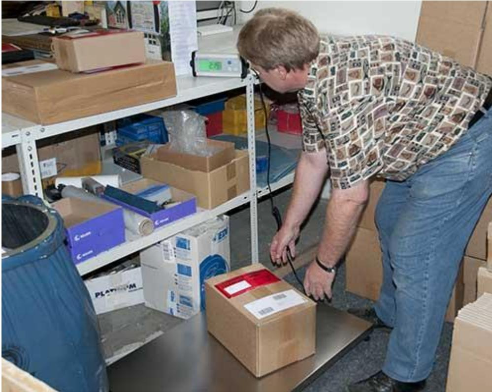
Imagen de uso de la balanza de plataforma PCE-PS 150XL
