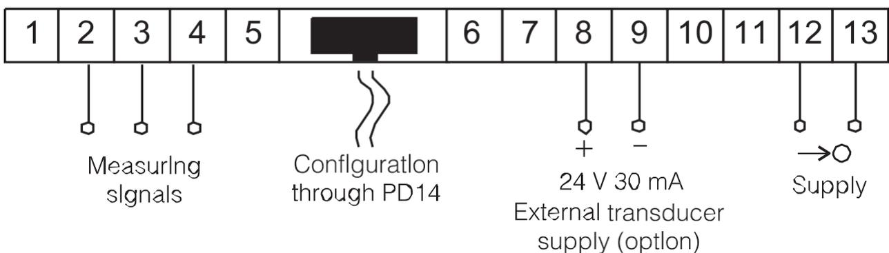
Fig. 4. Conexión eléctrica de los medidores N24T, N25T
