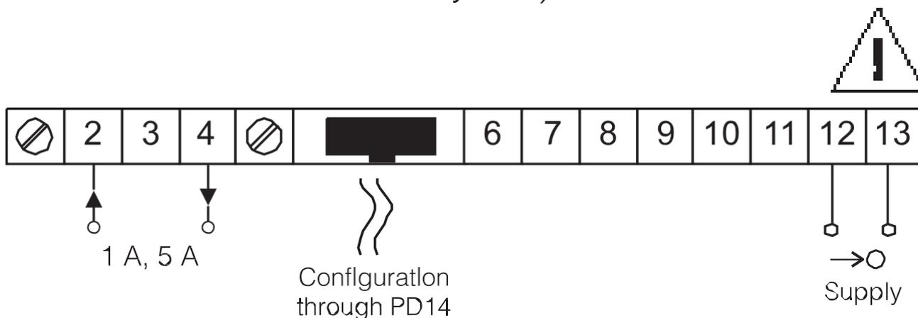
Fig. 7. Conexiones eléctricas del N24Z, N25Z y N24H, N25H para la medición actual.
