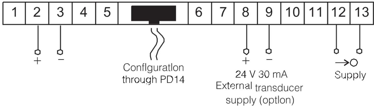
Fig. 3. Conexión eléctrica de los medidores N24S, N25S
