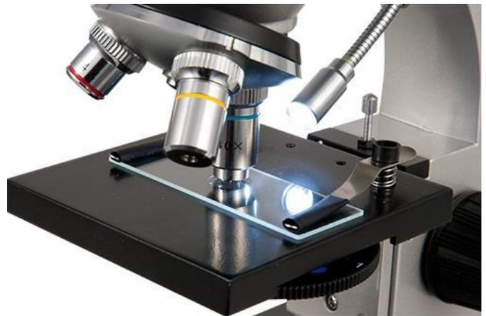
Au-dessus du pied se trouve le support, où se fixe la platine et le porte-échantillons. Avant que la lumière ait atteint la préparation, elle se focalise à travers la lunette du condensateur.
