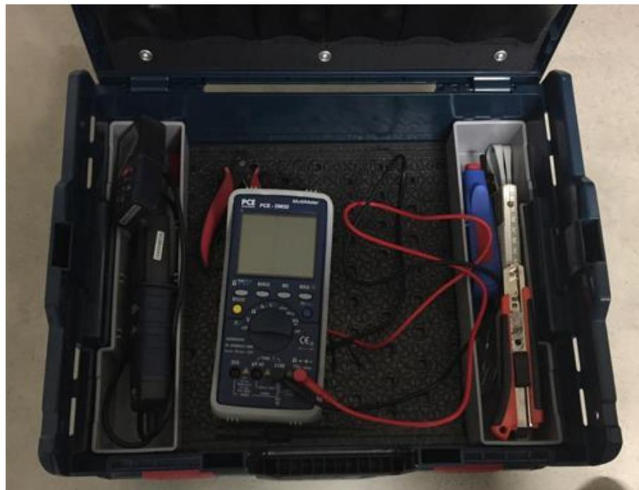
En plus des fonctions typiques d'un multimètre, le PCE-DM 32 a une interface série qui permet de transférer les valeurs de mesure au PC. Si on le compare avec d'autres multimètres compris dans cette gamme de prix, le multimètre a un très grand écran qui indique les valeurs de mesure mais aussi où doivent être introduits les câbles de mesure.
