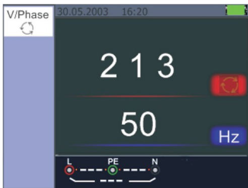
Fig. 5.2.8.4 Sequenza di fasi quando collegate in senso antiorario.
