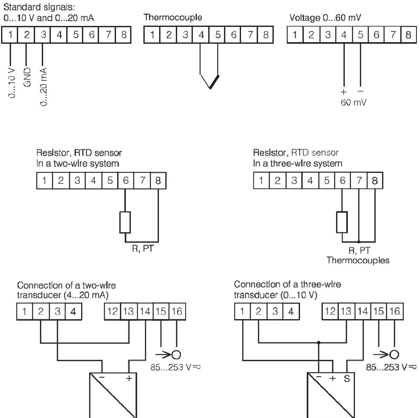
Fig. 5. Tipi di connessione del misuratore
