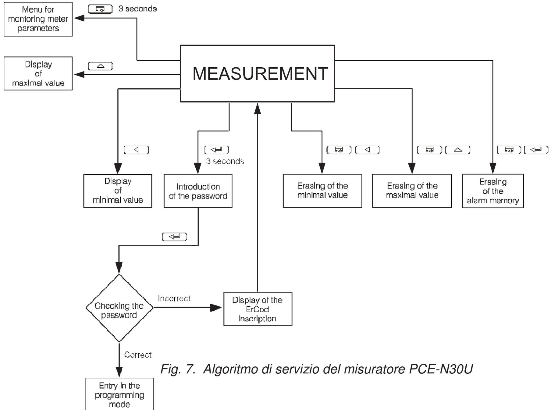
Fig. 7. Algoritmo di servizio del misuratore PCE-N30U
