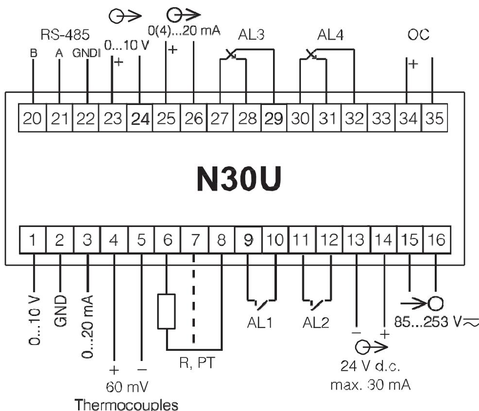
Fig. 4. Descrizione dei segnali nelle strisce di collegamento
