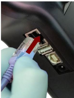
Collegamento del cavo Ethernet
