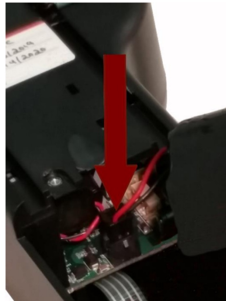
Passo 4 - Inserire lo spinotto di connessione della batteria nella presa corrispondente sulla scheda elettronica nel vano batteria
