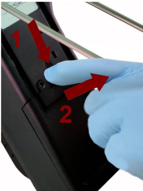
Passo 3 - Premere l'elemento di aggancio tirando il coperchio del vano batteria verso l'esterno
