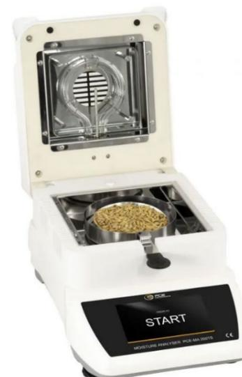
**Bilancia per la determinazione precisa dell'umidità assoluta di diversi materiali / Display touch screen / Funzionamento semplice / Memoria per 32 misurazioni / Software opzionale**
