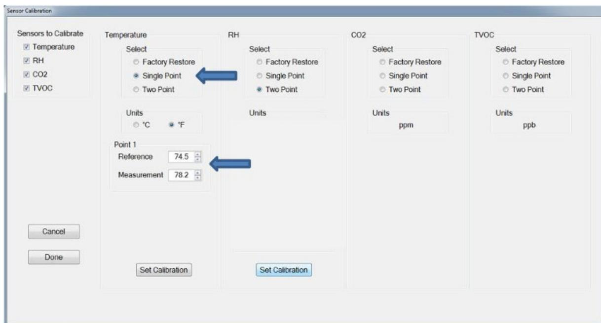
1. **Calibrazione o compensazione di un punto** - La funzione consente la compensazione di un singolo punto nel caso in cui sia possibile un solo punto di calibrazione di riferimento. (Un esempio potrebbe essere la temperatura dell'aria ambiente quando una camera ambiente non è disponibile - vedere immagine sopra).
