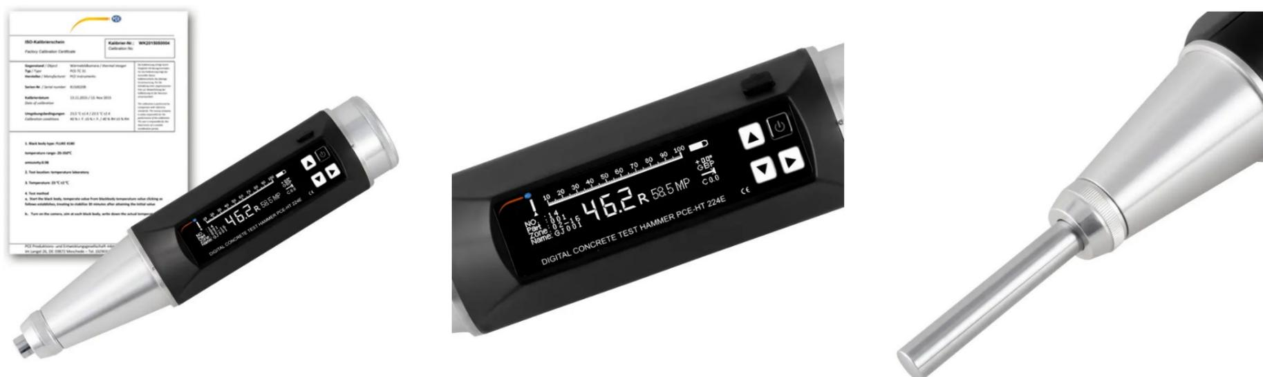
**Sclerometro con funzionamento meccanico e display OLED / Range di misura 10 ... 100 N/mm<sup>2</sup> / Software per analizzare i valori acquisti / Batteria integrata per uso mobile / Energia cinetica: 2,207 J / Per misurare la resistenza del cemento / Rapporto di taratura ISO incluso**
