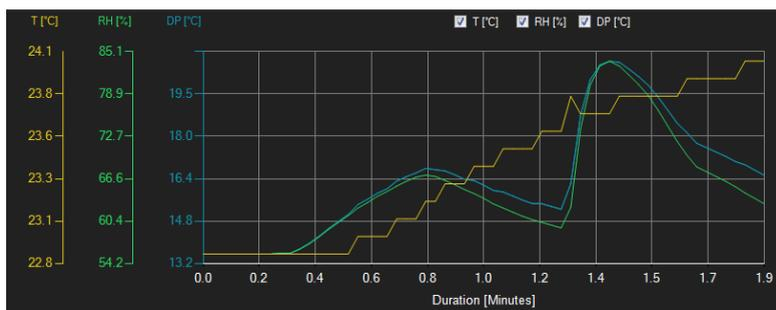
Muovendo il cursore del mouse su un punto della linea visualizzata si apre una piccola finestra di informazione con i dati (tempo e unità) del valore di misura selezionato.
