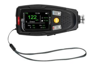
Spessimetro per rivestimenti con SSPC con un range di misura di 0 ... 2.000 µm / Micro USB / Funzione statistica / Funzione allarme / Misurazione di temperatura e umidità / Scanalatura a V / Software / Opzionale: Rapporto di taratura UNI EN ISO 9001
