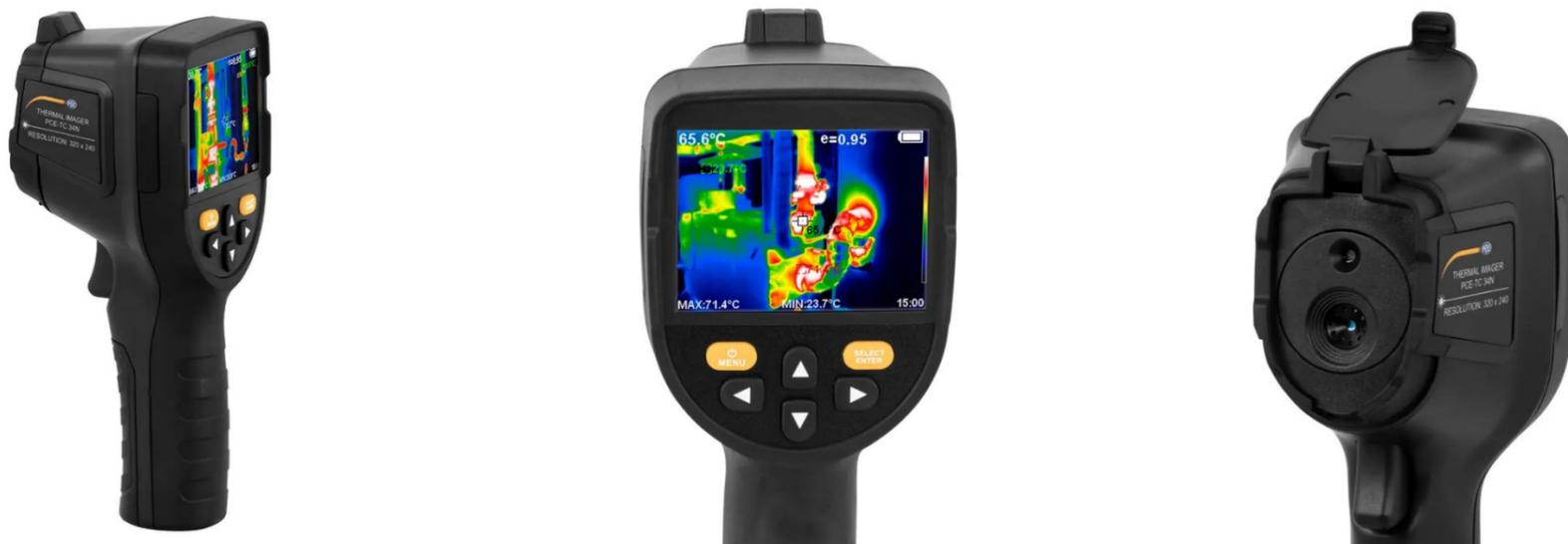
**Termocamera con una memoria da 3 GB / Differenti tavolozze di colore / Range di misura: -20 ... 300 °C / Funzione di immagine sovrapposta / Batteria intercambiabile / Menù disponibile in diverse lingue / Risoluzione dell'immagine: 320 x 240 pixel / Campo visivo: 35° x 26**
