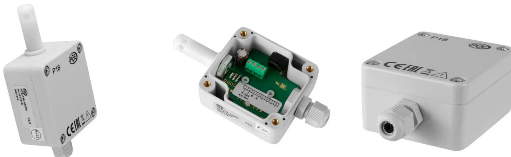
**Dispositivo per la rilevazione di temperatura e umidità relativa / Uscita come segnale normalizzato / Compatto / Interfaccia modbus RTU / Predisposto per essere montato su parete**
