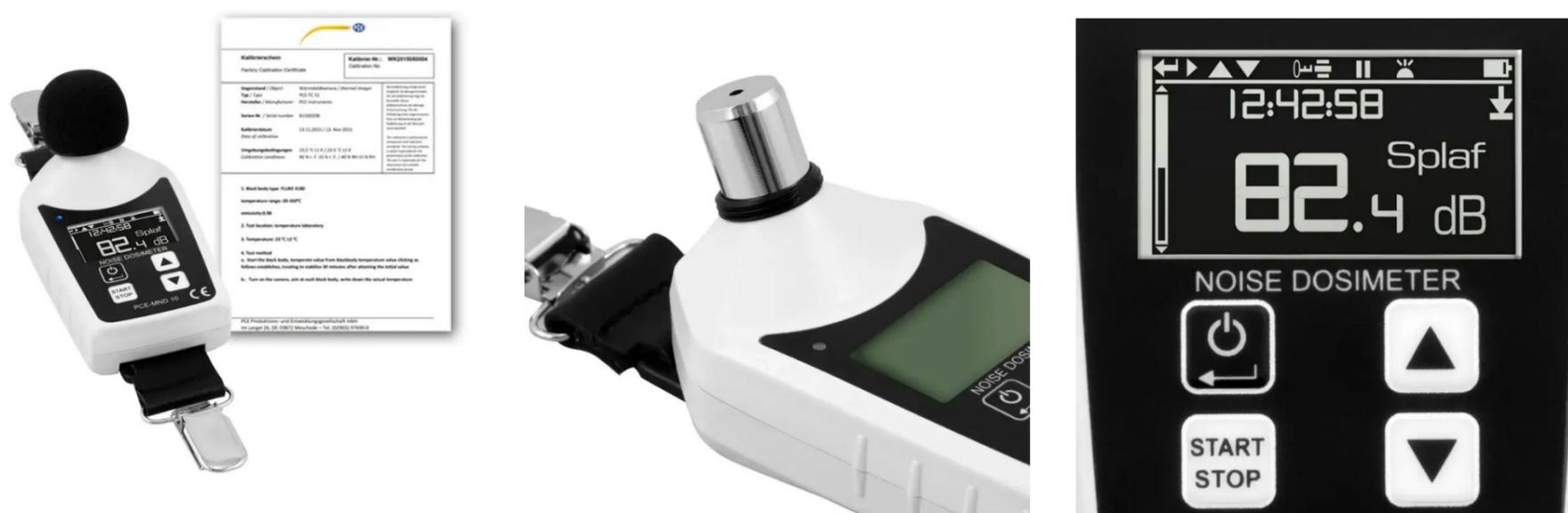
**Dosimetro acustico secondo IEC 61252:2002 / Range di misura: 70 ... 140 dB / Pinza a coccodrillo / Adatto per sicurezza sul lavoro / Autonomia della batteria > 15 ore / Interfaccia USB / Blocco tasti / Ponderazione di frequenza A, C e Z / Certificazione ISO inclusa**
