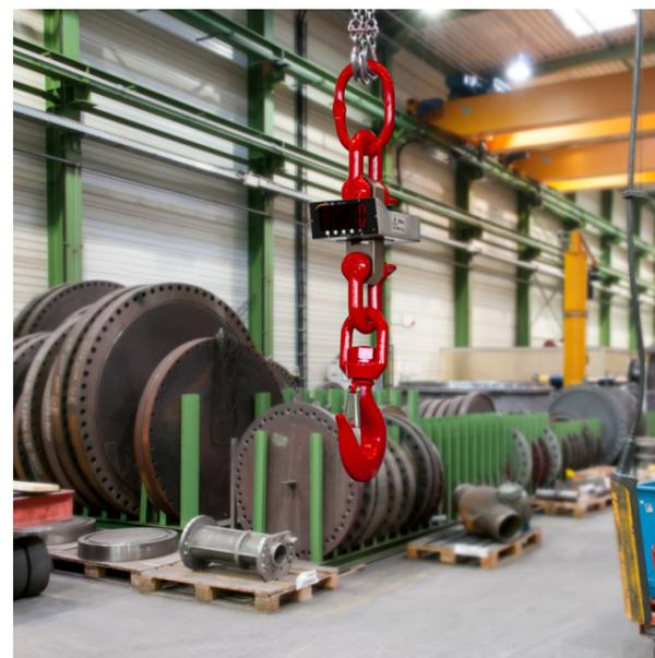
**Range di misura 25 t / Controllo con telecomando / Display con cifre da 75 mm di altezza / Funzione Hold, Tara e Somma / Batteria integrata da 7 Ah / Durata ≥ 40 h / Certificazione ISO inclusa**
