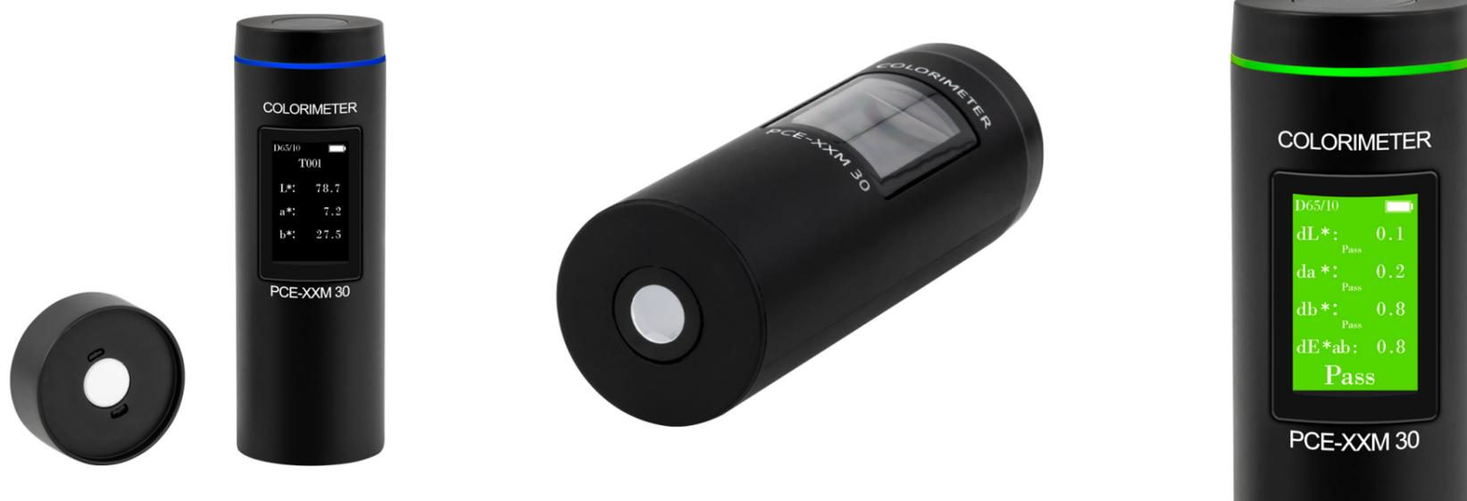
**Colorimetro con interfaccia Bluetooth / Funzione Pass/Fail / Autonomia: circa 10.000 misurazioni per carica / Lunghezza d'onda: 400 ... 700 nm / Memoria / Spazi di colore: CIE-LAB, CIE-LCh, HunterLab, CIE-Luv, XYZ, RGB**
