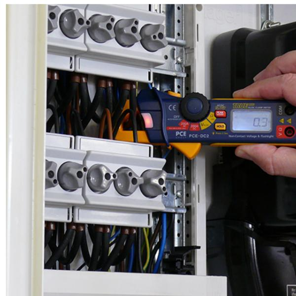
**Pinza amperometrica digitale per corrente AC/DC, tensione AC e resistenza / Apertura massima della pinza 18 mm / Certificazione ISO inclusa**
