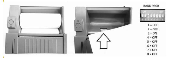
Adesso è possibile collegare la stampante tramite interfaccia RS-232 con il display della bilancia. È necessario utilizzare il cavo fornito alla consegna.
