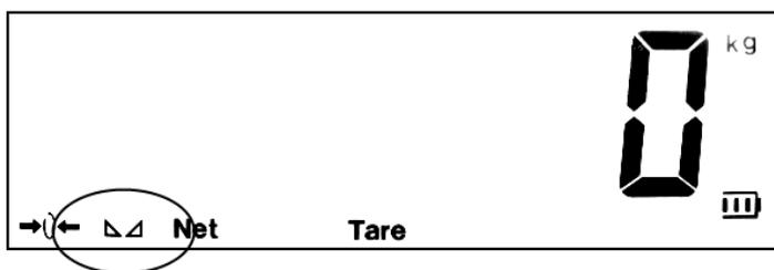
Se la bilancia non risponde, controllare che il display sia ben collegato all’alimentatore. Se l’indicatore di stabilità non appare sullo schermo, controllare la superficie su cui è stata posizionata la bilancia e collocarla bene.
